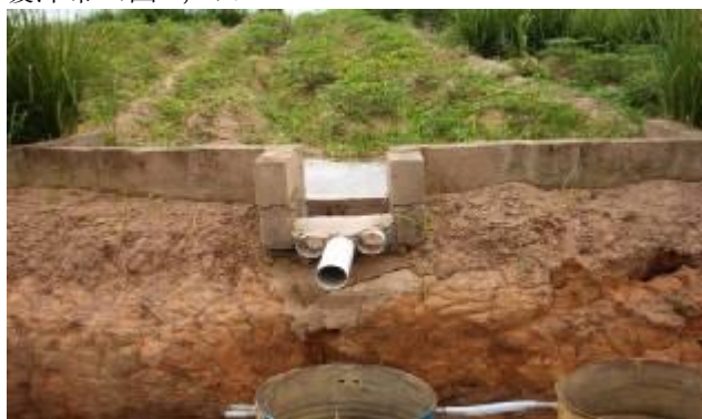
图3 农民实践小区(左,无侵蚀控制措施)图4 小区最低处沟中安置的沉积收集桶(右图,香根草篱作为控制侵蚀措施)
