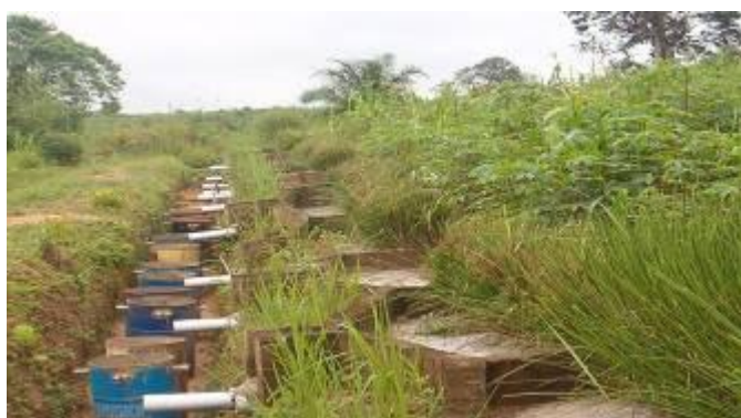
图3 农民实践小区(左,无侵蚀控制措施)图4 小区最低处沟中安置的沉积收集桶(右图,香根草篱作为控制侵蚀措施)
