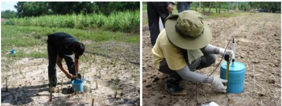
图 2 土壤气罐(左)及利用手动 CO 2 计测量 CO 2 排放速率(右)
